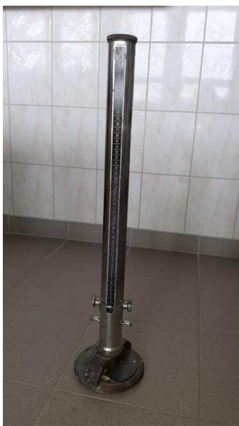
Rys.3. Badanie odporności powłok malarskich na uderzenie w aparacie Du Ponta
