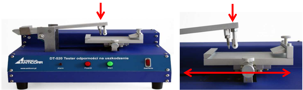
Rys.2. Oznaczenie odporności na zarysowanie w przyrządzie Clemena (Anyicor)
